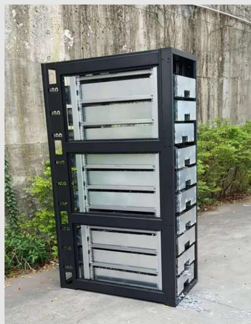
承重测试, 每个铁箱放置 220KG 铁片, 合计重量 2200KG
