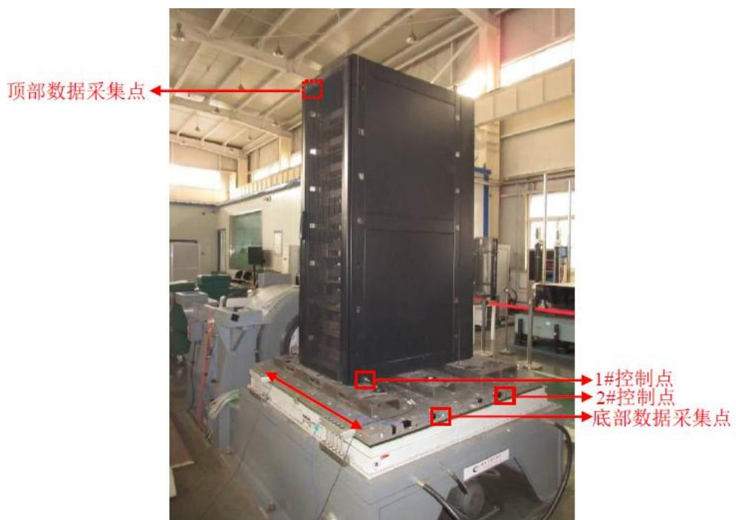
图 5：机柜动态测试现场照片
