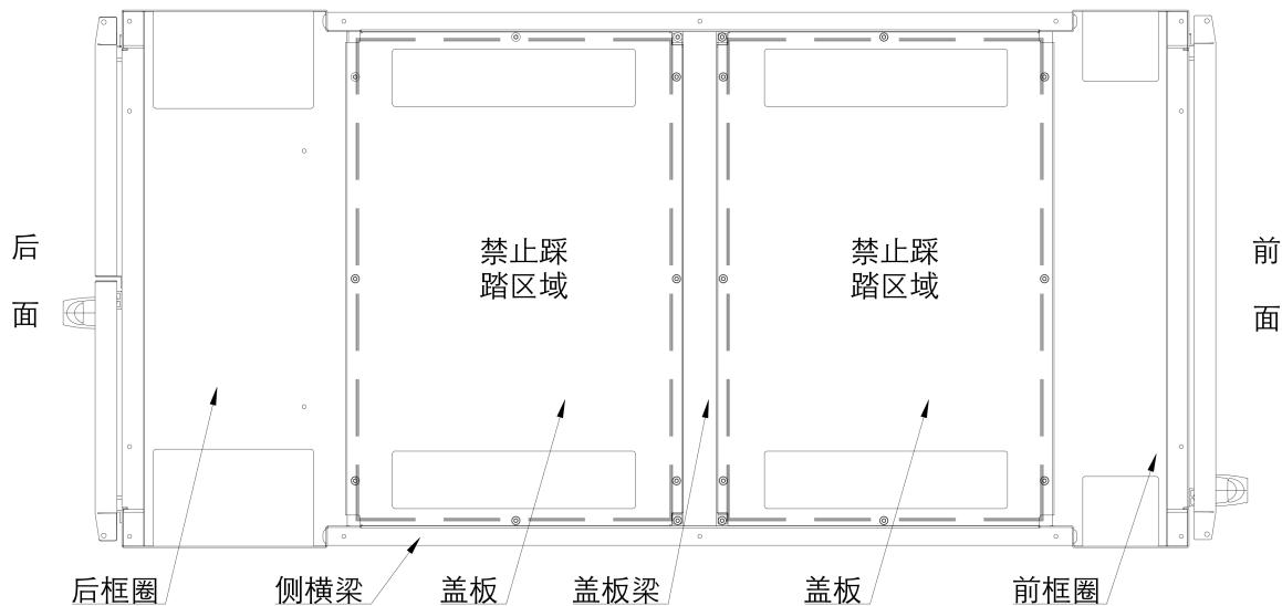
图 8：机柜顶部禁止踩踏区域示意图
