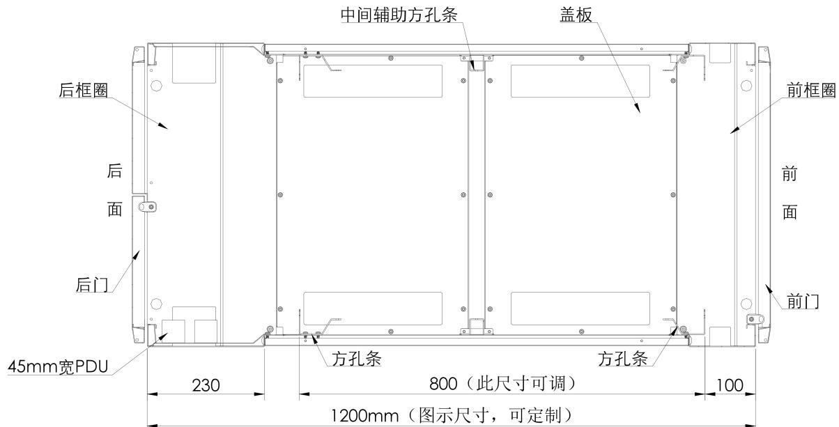
图 17：机柜内部方孔条安装位置示意图
