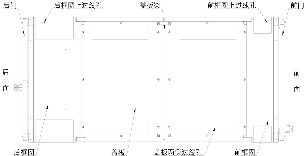
图 24：机柜顶部过线孔位置示意图
