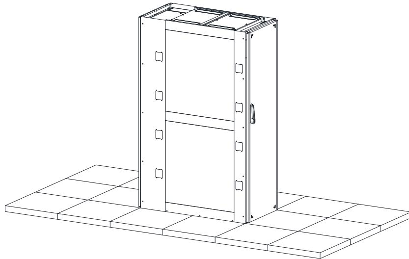
图 33：机柜直接安装于静电地板上示意图
