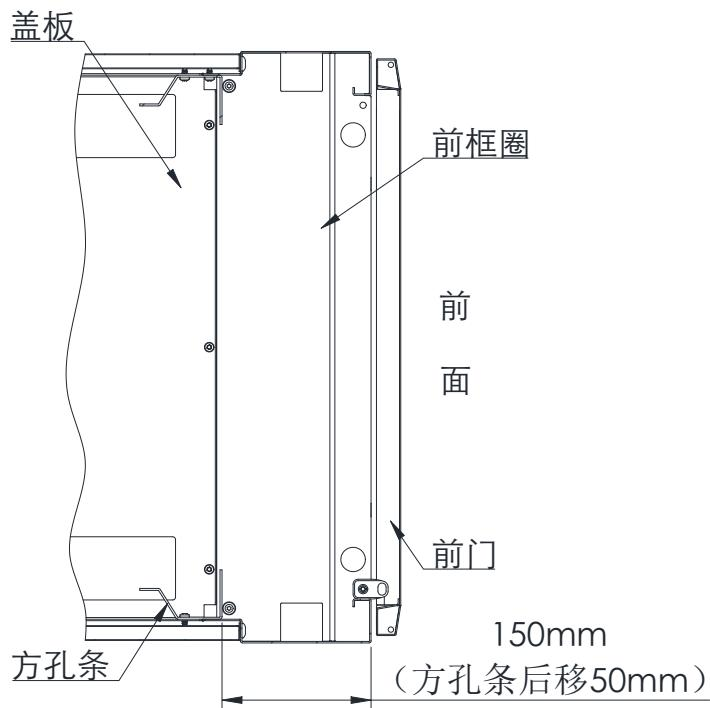
图 14：机柜方孔条后移密封示意图
